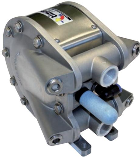
*Doppelmembranpumpe aus Aluminium. Wegen der schnellen Umschaltzeit benötigen die Pumpen bis zu ca. 30% weniger Druckluft. Außer der 1:1-Pumpe wird auch eine 3:1-Version für einen Mediendruck bis 20 bar angeboten.*
