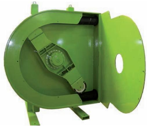
*Der Pumpenschlauch wird bei der ALX150 mit extrem großen Rollen gequetscht.*
