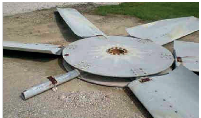
Abbildung 1: Kostenintensiver Schaden an einem großen Lüfter infolge hoher Vibrationen
