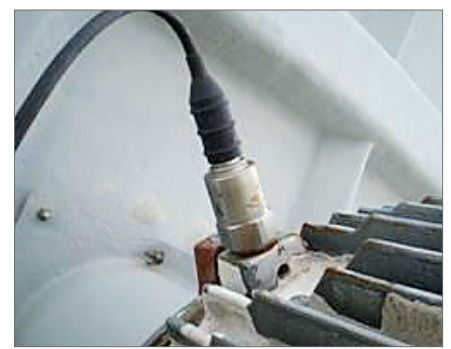
Abbildung 4: Über USB programmierbarer Smart-Vibrationsschalter von IMI, montiert an einem Motor
