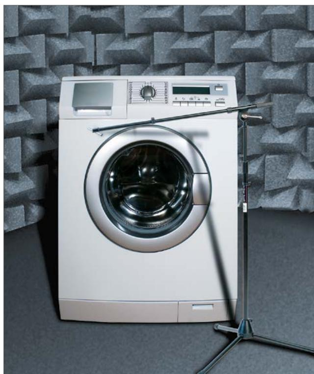
Ermittlung der Schallquellen bei Haushaltsgeräten zur Reduzierung der Betriebsgeräusche
