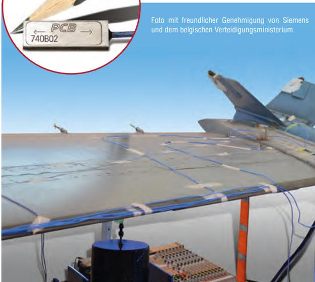
Dehnungssensoren des Modells 740B02, installiert an einer Verbundflügelstruktur.
