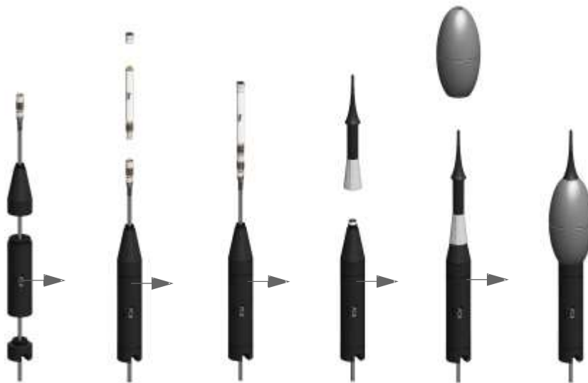
Abbildung 2-1 Aufbau des PRM2103-FF und Montage mit dem EPS2116
